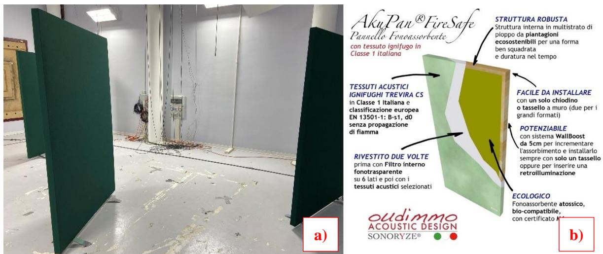
**Figura 1 – Configurazione di prova: a) elementi discreti testati; b) stratigrafia del materiale testato.**
