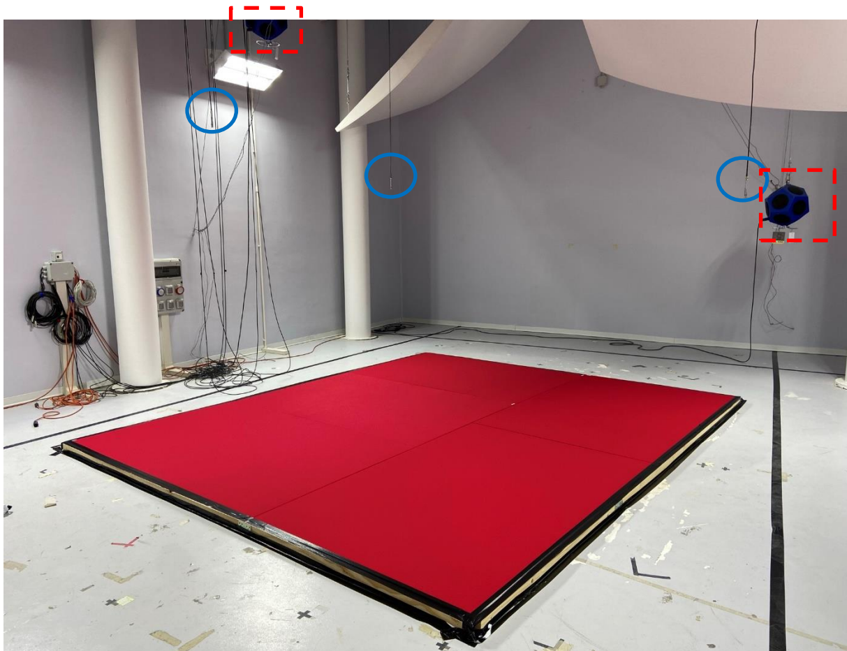
Figura 2b – Punti di misura: blu – posizioni microfoniche; rosso – posizioni sorgenti.
