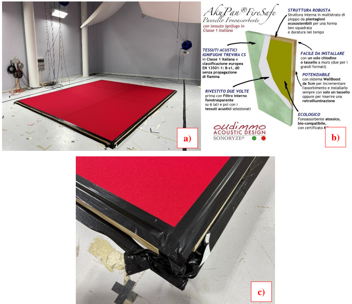
Figura 1 – Configurazione di prova: a) provino totale; b) stratigrafia del materiale testato; c) zoom della sigillatura laterale, con nastro telato e telaio in legno.
